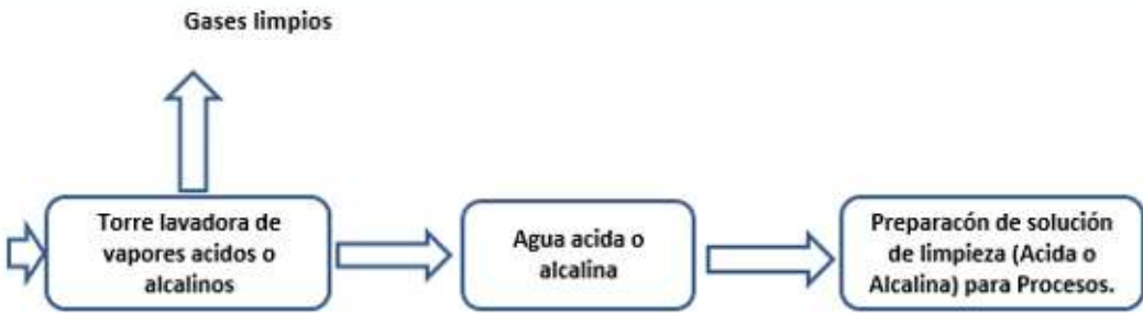
Torre lavadora de vapores acidos (1) y alcalinos (3)
